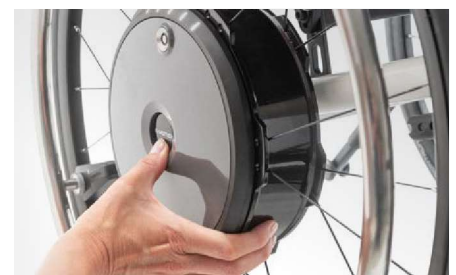
Zur Abnahme des Rades Steckachsenkopf drücken und Rad abziehen.
