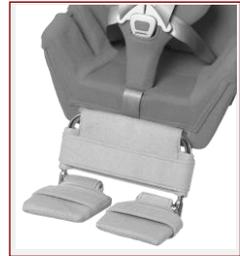
Nach dem Öffnen der Schrauben unterhalb des Rohrs lässt sich die Höhe der Fußbank einstellen. Danach müssen die Schrauben wieder fest angezogen werden
